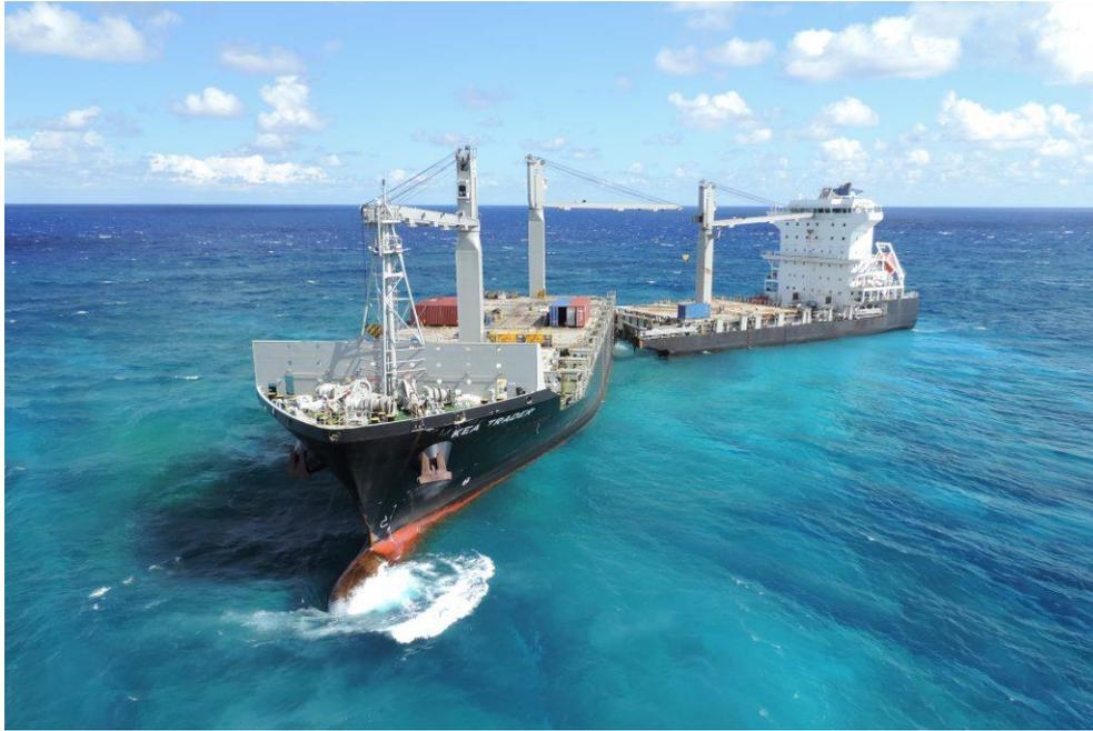
12 juillet 2017, échouement du porte-conteneur Kea Trader, bâtiment double coque de 25000 tonnes et 185m de long, en vitesse de croisière sur le récif Durand (400m à l'intérieur du récif), à 140 nautique de Nouméa.
